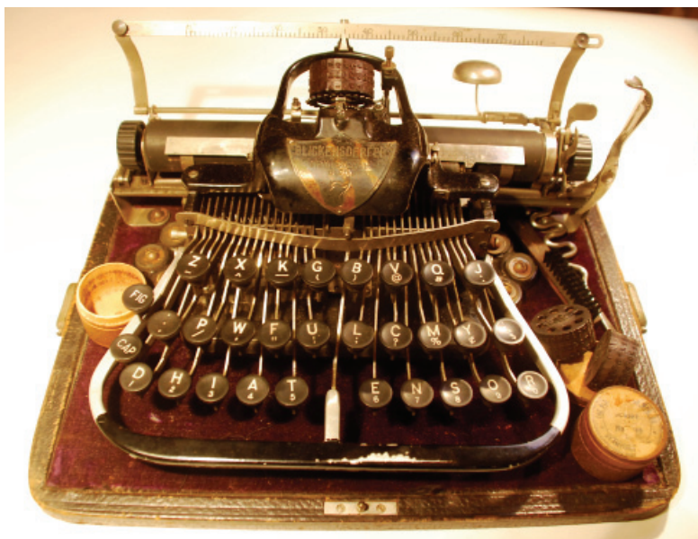
Rysunek 18. Maszyna do pisania Blickensderfer (USA, koniec XIX wieku), z wymiennymi główicami z czcionkami (w drewnianych pudełkach) oraz klawiaturą Morse'a
