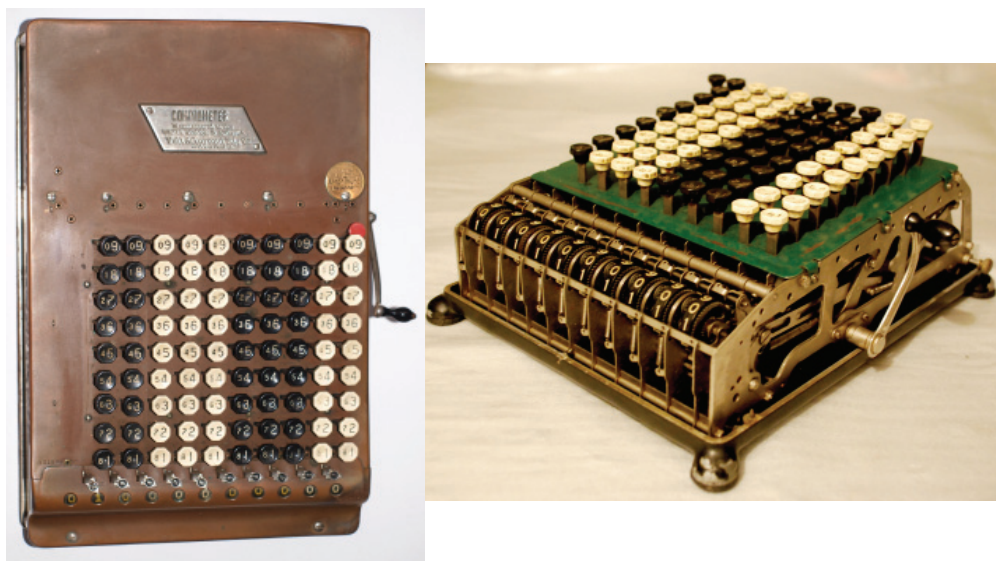
Rysunek 14. Wczesne kalkulatory pełnoklawiaturowe: Comptometer i Burroughs model 5 (z odsłoniętym mechanizmem)
