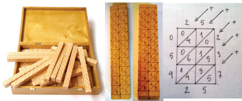
Rysunek 3. Pałeczki Napiera – wyrób współczesny. Ustawienie pałeczek do wykonania iloczynu 25 x 237 i schemat dodawania w tym przypadku
