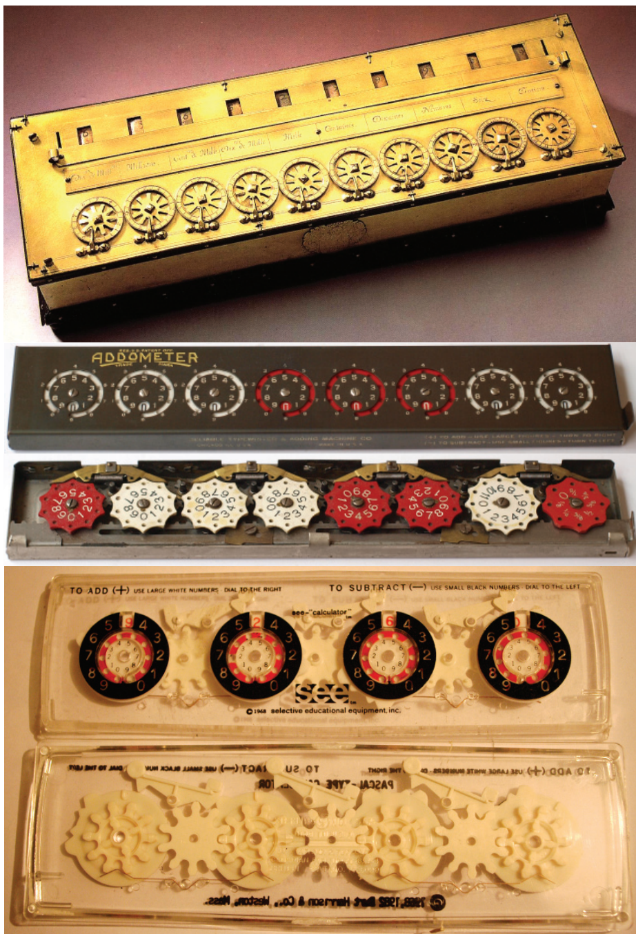
Rysunek 5. Pascalina ze zbiorów muzeum Salonu Aparatów Matematycznych i Astronomicznych (Zwinger) w Dreźnie; Addometer, późniejszy kalkulator zbudowany na idei Pascaliny – widok zewnętrzny i widok mechanizmu; Kalkulator See z widocznym mechanizmem dodawania i przenoszenia
