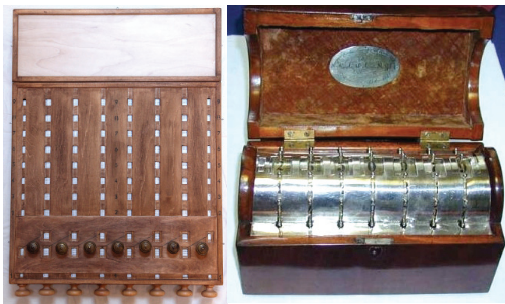
Rysunek 19. Replika maszyny Jakobsona z kolekcji Włodka (Waltera) Szreka (USA), wykonana przez Valérego Monnier (Paryż) i maszyna Staffela (Muzeum Techniki, Warszawa)
