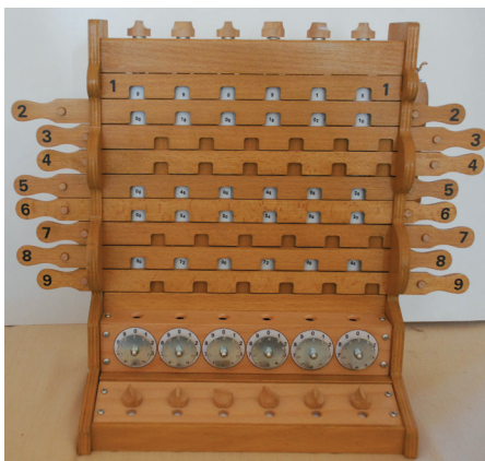
Replika kalkulatora Wilhelma Schickarda, zbudowanego w 1623 roku dla Johanna Keplera. Uznawany jest za pierwszy kalkulator.
