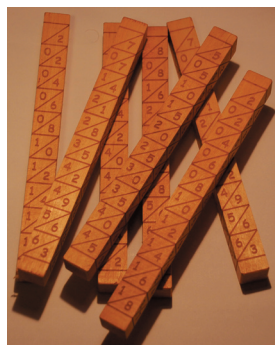
Pałeczki Napiera (wyrób współczesny). Wilhelm Schickard zmodyfikował je i wykorzystał w swoim kalkulatorze.
