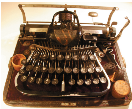
Blickensderfer 7 – maszyna do pisania z wymiennymi fontami i klawiaturą nie-QWERTY (koniec XIX wieku).
