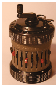
Curta II – najdoskonalszy kalkulator mechaniczny, skonstruowany przez Curta Herzstarka w czasie, gdy był więźniem w obozie w Buchenwaldzie.
